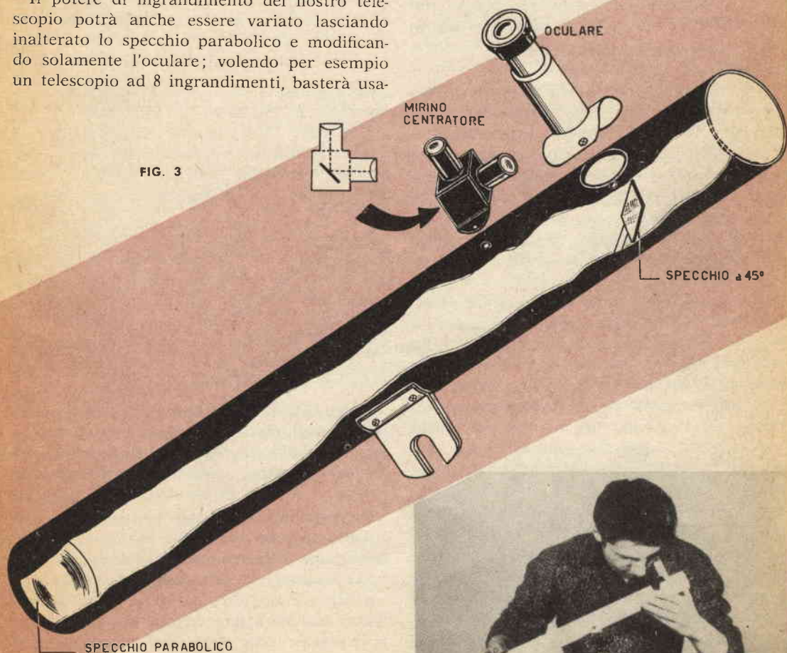
Fig. 3. Come è composto internamente un telescopio a riflessione.
