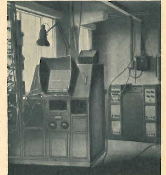
● Impianti interni della Stazione: al centro, il ricevitore e il tubo a raggi catodici; in fondo, l'apparecchio per la misura della velocità delle meteore.
